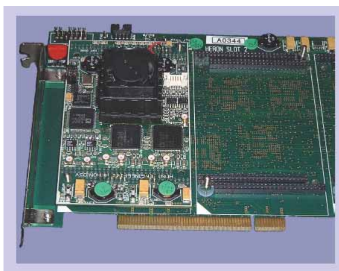
図5 ベースバンド部プロトタイプハードウェア
