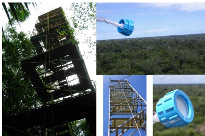
図4：アマゾン流域研究所試験林にある高さ約50mのタワー上での大気微生物採取
