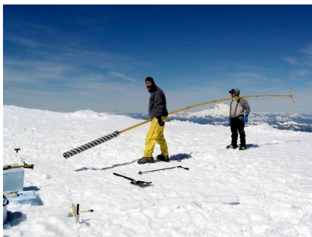
図2: チリ、オソルノ火山(標高2,661m,)山頂氷河でのアイスコア採取
