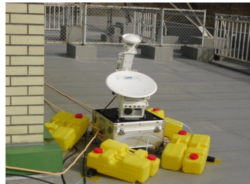
現地対策本部(釜石)に設置された可搬型 USATの外観写真(アンテナ径45cm)
