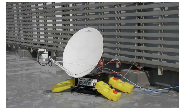
現地対策本部(大船渡)に設置された 可搬型VSATの外観写真(アンテナ径1.0m)
