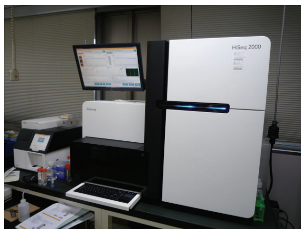
22 年度に導入した試料調製装置 c-BOT(左)と、HiSEQ2000 次世代型シーケンサ(右)。
