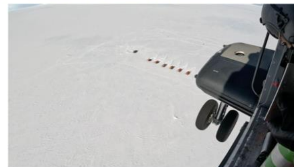
南極大陸S16でのペネトレータ投下試験
