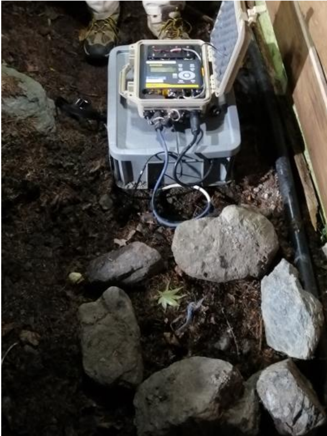
図 5. 山岳域での観測の様子。二軒小屋ロッチに設置した地震観測装置(石で囲まれた地中に設置されている)、データ収録装置、バッテリーの写真。アクセスの難しい高山域で観測を続けていることを示す。(楠城一嘉撮影)
